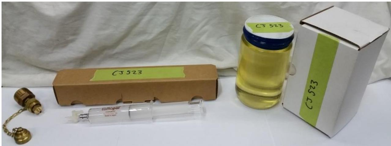
Figure 1: Soupape d'échantillonnage, seringue et bocal avec leurs boîtes
